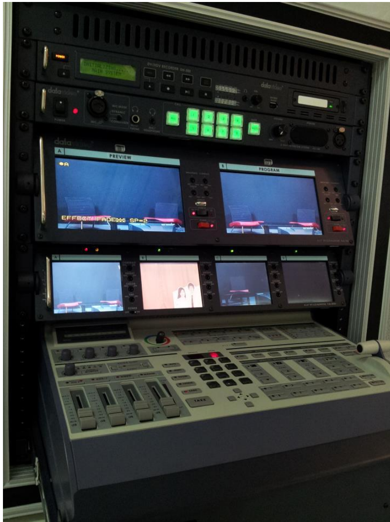
เครื่องสลับสัญญาณภาพ SE-800 (ตัว Mixer ตัวล่างสุด)
